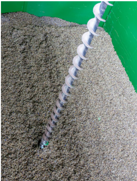
Container-Trocknung mit automatischem Rührwerk und doppeltem Boden.
