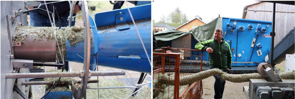
**Abbildung 29:** Die Heustränge werden gewickelt (links) und in einem Gitter (rechts) transportfähig zwischengelagert. © DVL
