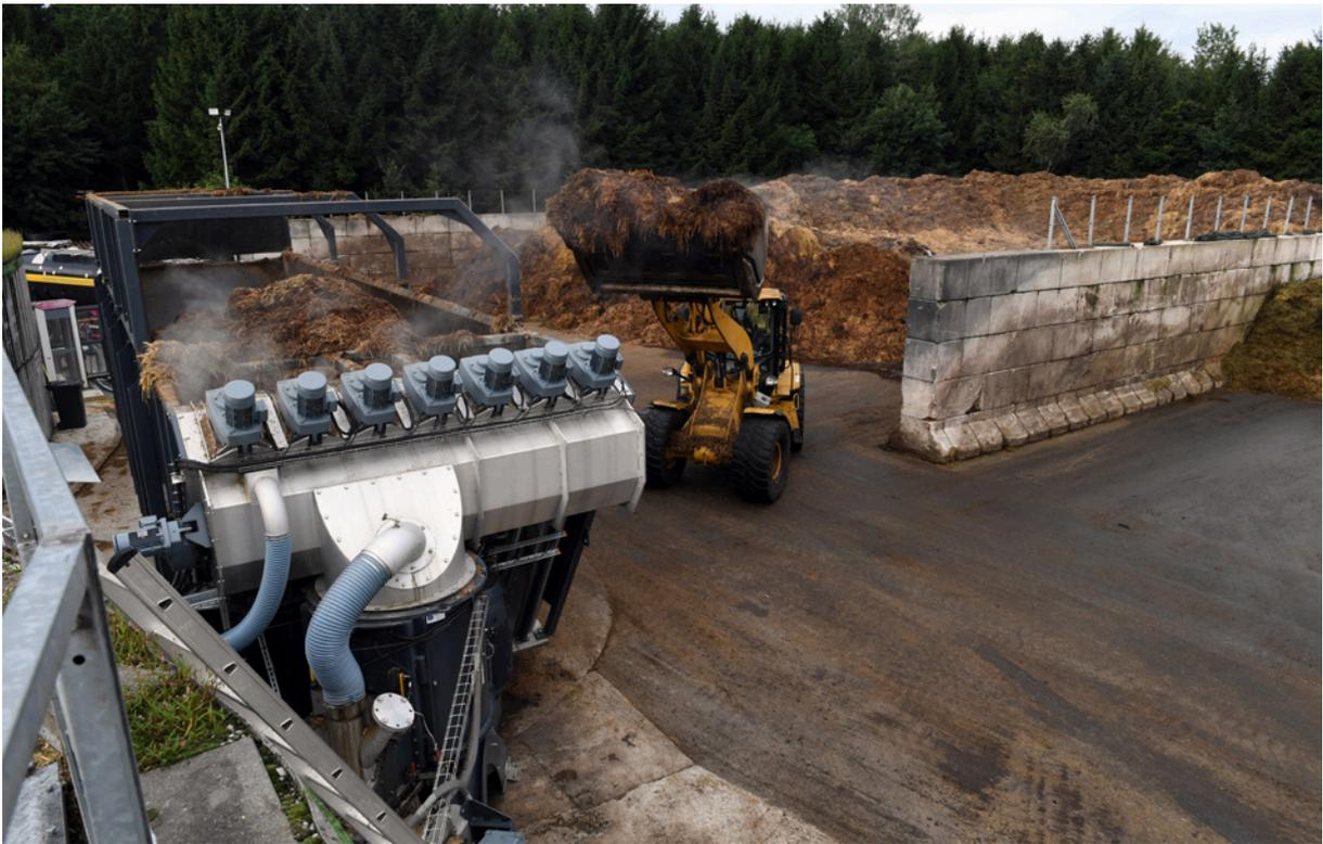
**Abbildung 22:** Ein Radlader befüllt einen Schredder. Der Schredder speist das gekürzte Substrat direkt in den Vorgärer ein.
