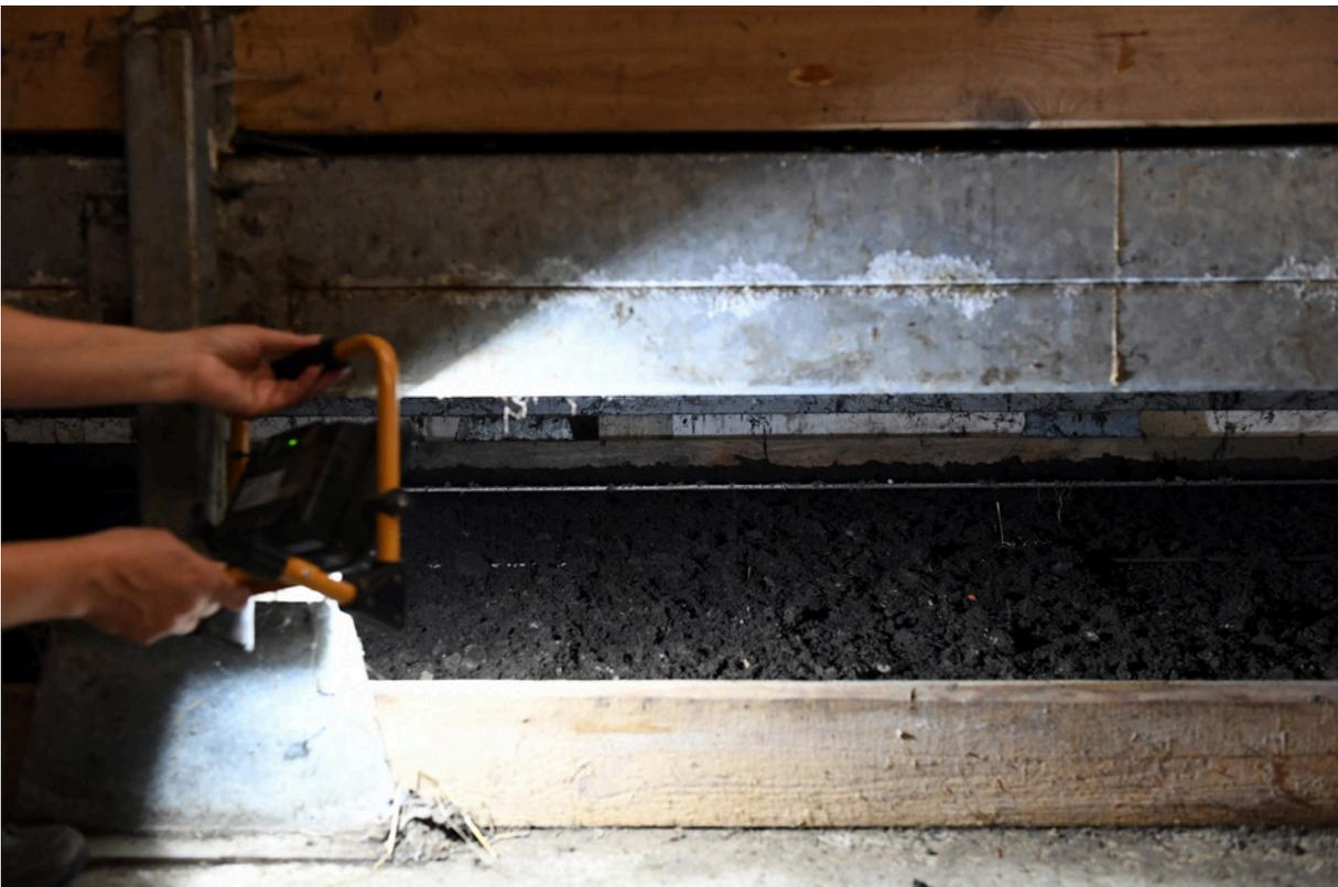
**Abbildung 19:** Der fertige Kompost liegt auf einer Baustahlmatte auf und wird von unten entnommen. Hierfür gibt es auch Seilzugsysteme: Ein Messer, das am oberen Seil befestigt ist, schneidet den Kompost ab. Dieser fällt in eine Schale, die am unteren Seil befestigt ist.
