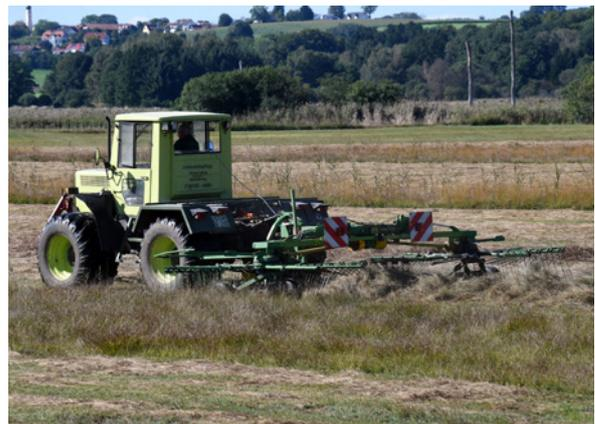
**Abbildung 7:** Die Verminderung des Bodendrucks, etwa mit Breit- oder Gitterreifen, leichten Fahrzeugen und Maschinen erleichtert die Befahrung auf nassen Flächen.
