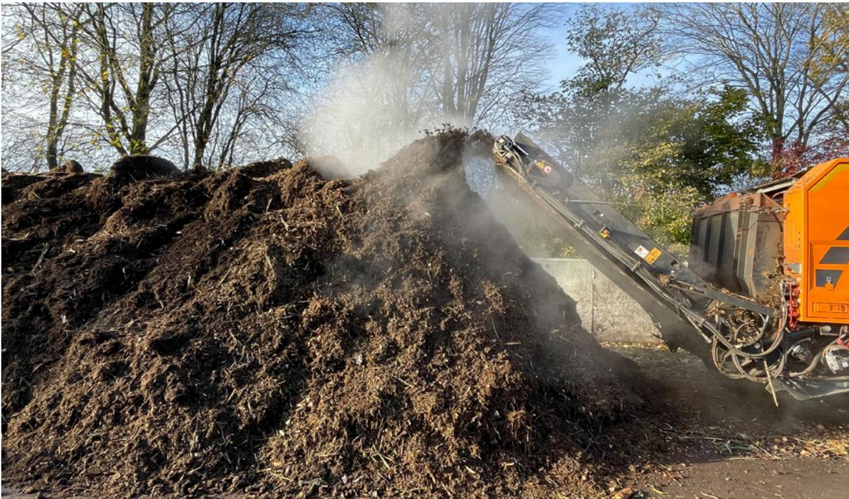
**Abbildung 14:** Kompostsubstrat wird mit einem Schredder zerkleinert und in Mieten aufgeschichtet. Der Dampf über der Miete deutet auf mikrobielle Aktivität hin. © KBM
