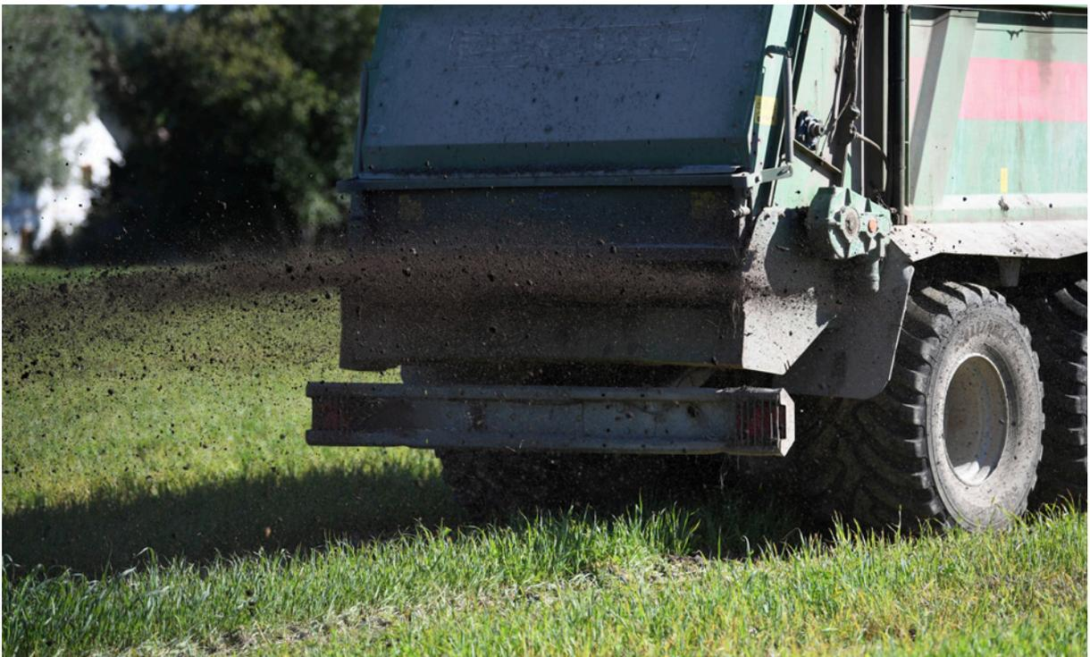
**Abbildung 13:** Kompost kann z. B. mit einem Miststreuer ausgebracht werden – hier mit einem integrierten Stauschieber.
