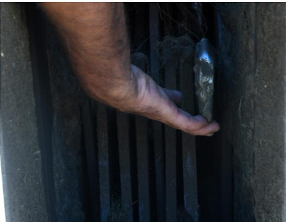
**Abbildung 24:** Die Schlegel der Stroh­mühle reißen das Land­schaf­tpflegegras auf. Durch regelmäßiges Aufschweißen der Kanten halten die einzelnen Schlegel länger.
