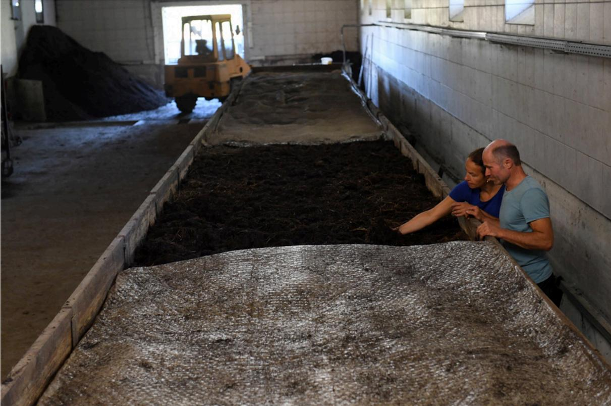
**Abbildung 18:** Etwa alle zwei Wochen wird der Kompostbox 4 m<sup>3</sup> Substrat zugeführt und anschließend mit der Plane abgedeckt. Ein Erntevorgang ergibt in etwa 1 m<sup>3</sup> Kompost und wird alle zwei Wochen wiederholt.
