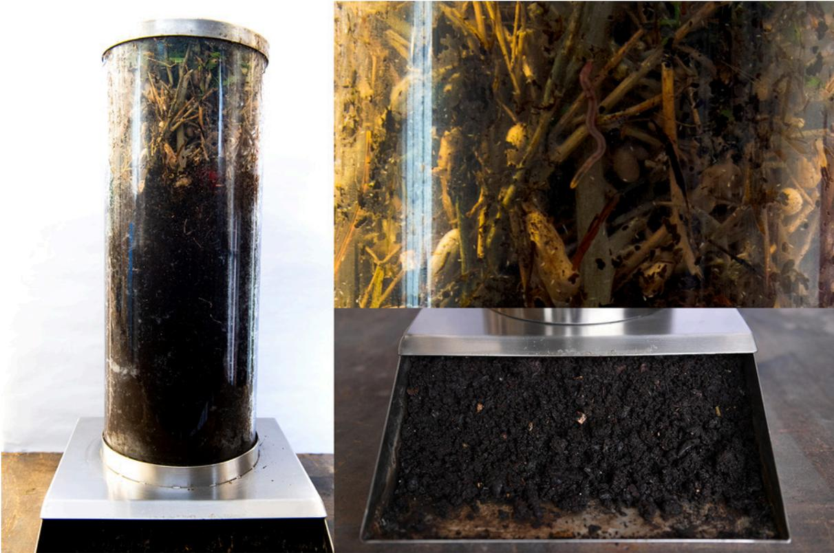
**Abbildung 16:** Im Glas ist der angesetzte Wurmkompost im oberen Bereich reich an Würmern. Im unteren, bereits kompostierten Bereich sind kaum Würmer mehr zu finden.
