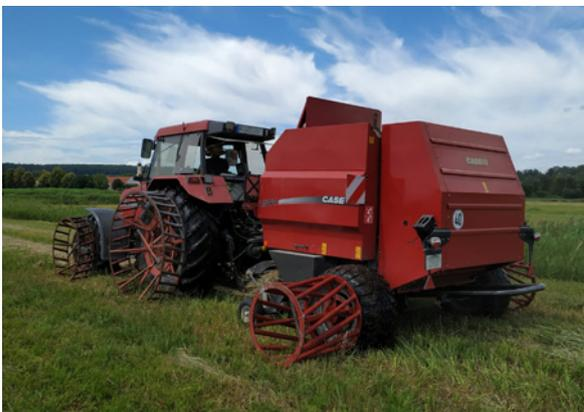
**Abbildung 6:** Zwillingsbereifung mit Gitterrädern verhindert, dass sich Schlamm vor den Reifen ansammelt.
