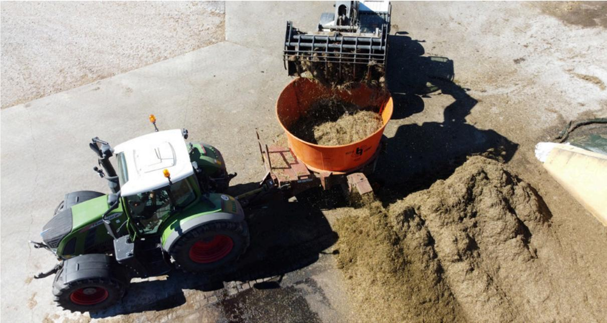
**Abbildung 23:** Landschaftspflegegras wird in der Stroh­mühle geschreddert und anschließend direkt in die Biogasanlage eingespeist.
